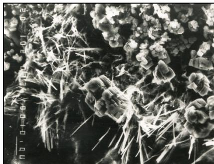
Slika 2: Početak XYPEX kristalizacije betona
